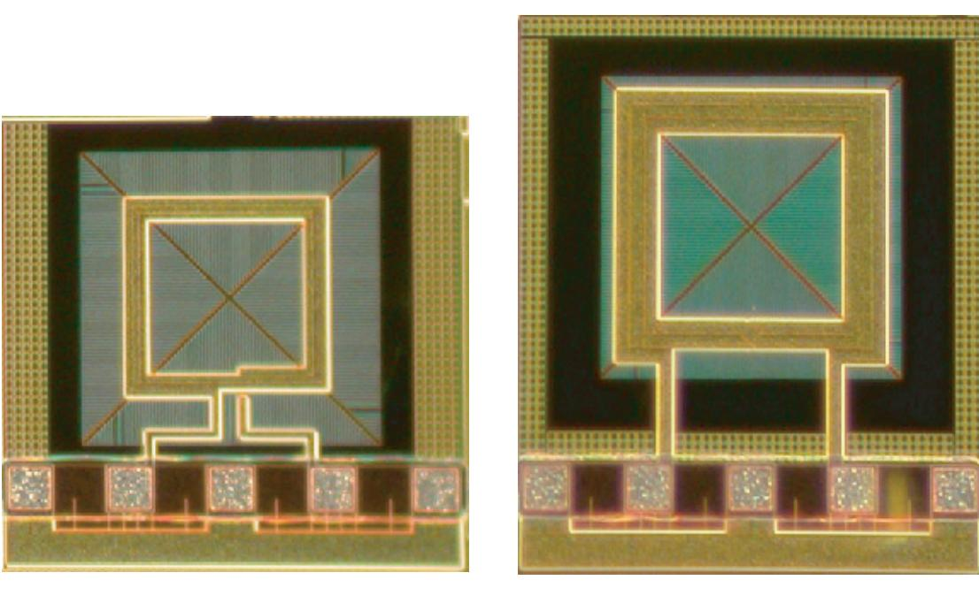
L<sub>1</sub> Turns : 3 Line width : 10 μm Line space : 1.2 μm Outer diameter : 300 μm
